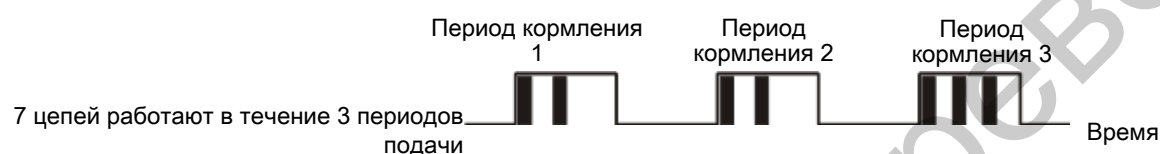
Рисунок 8: Цепная кормораздача: Пример 1: Распределение количества проходов цепи
